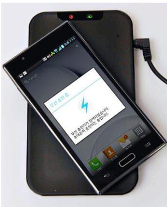
Am weitesten verbreitet ist die Methode der *induktiven Energieübertragung*, im Nahbereich von einigen Zentimeter mit vergleichsweise hohen Wirkungsgrad im Bereich um 90 % anwendbar.
