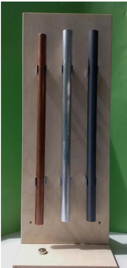
Bewegt sich ein Magnet in einem Leiter, wird Strom erzeugt.
