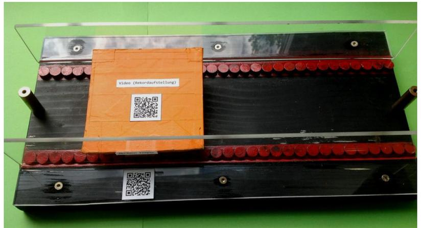
Die Magnetschwebebahn basiert auf der magnetischen Abstoßung von zwei Magneten (Nordpol-Nordpol oder Südpol-Südpol).
